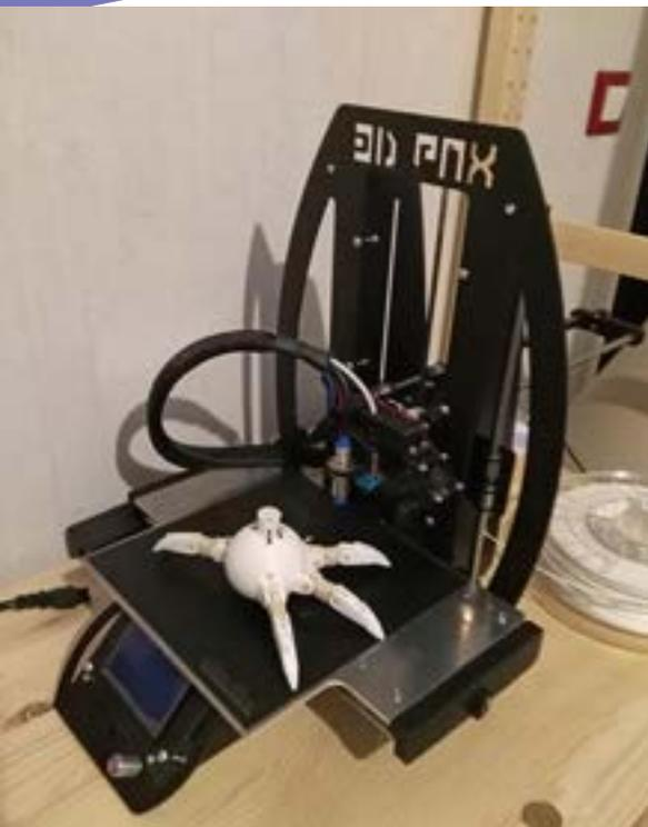
Le prototype d'une patte avec des serres articulées, afin de permettre à un oiseau de se tenir debout malgré une amputation.
